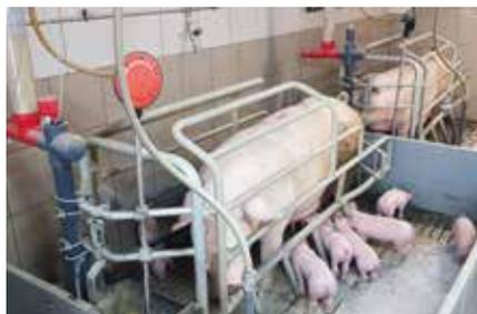
Bei der **MamaDos Sauenfütterung** handelt es sich um einen Futterdosierer, welcher direkt unter einem handelsüblichen Volumendosierer montiert wird und die Sau individuell mit Futter versorgt. Mit dem **MamaDos Fütterungssystem** kann somit eine höhere Futteraufnahme erzielt werden.
